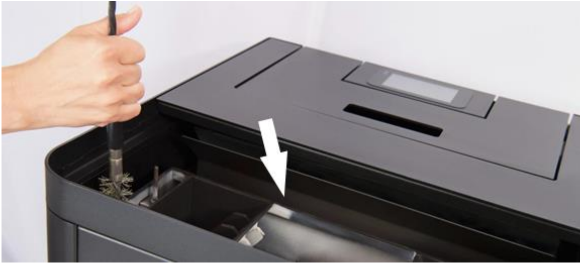
Rauchgaszüge von oben, diese sind zu reinigen
